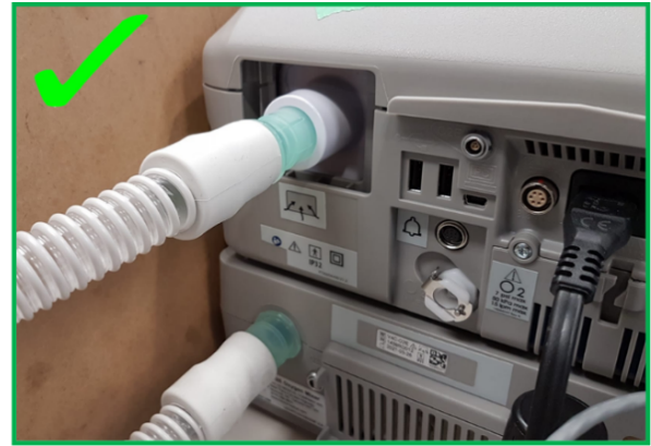
Figure 4-10. S'assurer d'enlever tout filtre situé au niveau du raccord conique qui dépasse à l'arrière du ventilateur.
