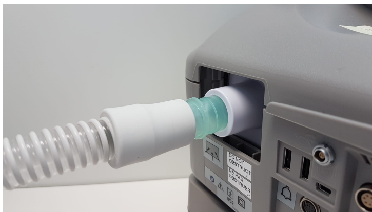
Figure 4-9. Tube de raccordement au gaz et adaptateur branchés au ventilateur.
