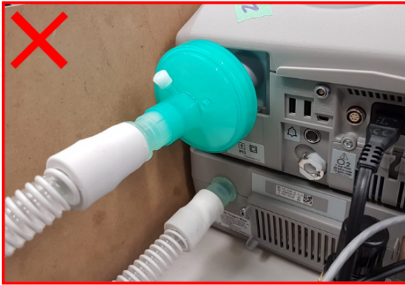
Figure 4-10. S'assurer d'enlever tout filtre situé au niveau du raccord conique qui dépasse à l'arrière du ventilateur.
