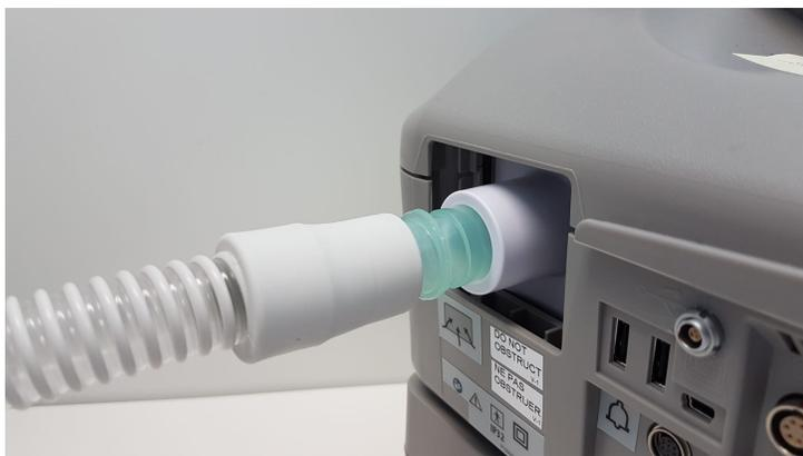
**Figure 4-10.** S'assurer d'enlever tout filtre situé au niveau du raccord conique qui dépasse à l'arrière du ventilateur.
