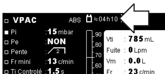
Les alarmes Batterie faible et Batterie déchargée (voir le chapitre 3, [Alarmes et dépannage](#)) se déclenchent quand la réserve de la batterie interne est réduite.
