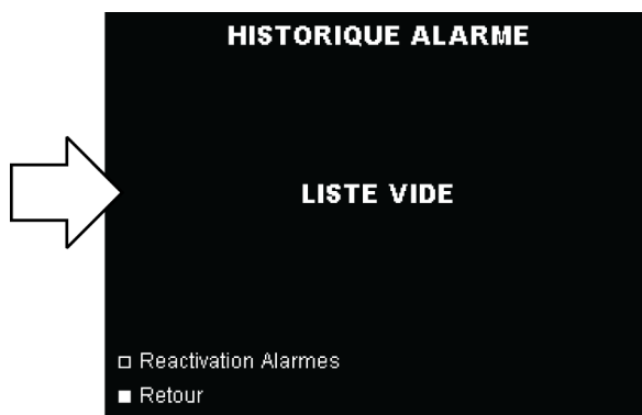
Figure 5-5. Écran Historique alarme (aucune alarme activée)
