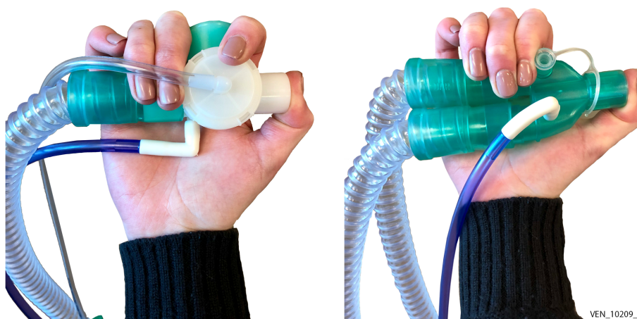
Figure 10-1. Blocage du circuit patient (circuit à une branche à gauche; circuit à deux branches à droite)
